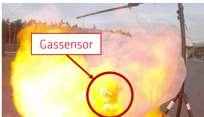
Gassensor in einer unverdämmten Gasexplosion (200 Liter Methan-Luft-Gemisch)
