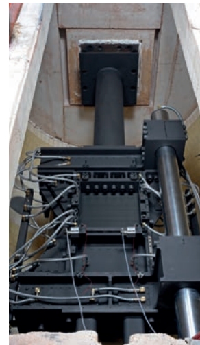
Intermediate-scale Versuchsstand im Stützenprüfofen der BAM
