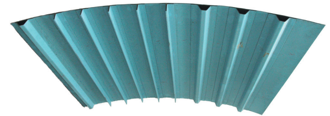
Original CFK-Luftfahrtstruktur mit Längsversteifungen
