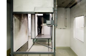
Prüfung im Single Burning Item Test (außer Fußbodenbeläge) nach DIN EN 13823 und im Radiant Panel Fußbodentest nach DIN EN ISO 9239; bzw. Brandschacht DIN 4102-1, -15, -16 (ohne Foto)
