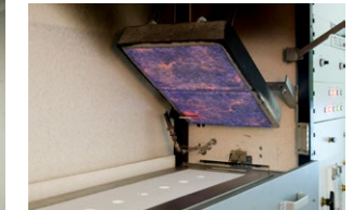
Prüfung im Single Burning Item Test (außer Fußbodenbeläge) nach DIN EN 13823 und im Radiant Panel Fußbodentest nach DIN EN ISO 9239; bzw. Brandschacht DIN 4102-1, -15, -16 (ohne Foto)
