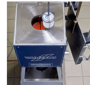
Prüfung im Nichtbrennbarkeitsöfen nach DIN 4102-1 bzw. DIN EN ISO 1182
