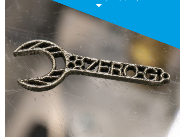
Der erste Schraubenschlüssel aus Metall, der per 3D-Druck in Schwerelosigkeit gefertigt wurde
