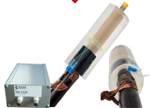
Integration in Silikon-Aufschiebeelementen und Aufbau eines Auswertesystems
