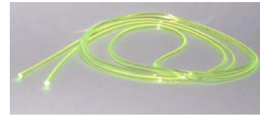
Entwicklung von fluoreszierenden Silikonfasern als Sensorelement
