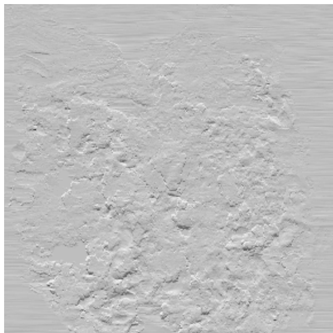
Abb. 25.2 Ergebnisse der Schlagfunkenversuche mit Luft zur Ermittlung der Wahrscheinlichkeit zur Erzeugung oxidierter Funken in Abhängigkeit zur Oberflächenrauigkeit bei W = 10 \text{ Nm} mit St52/St52 und nach 200 Schlagvorgängen
