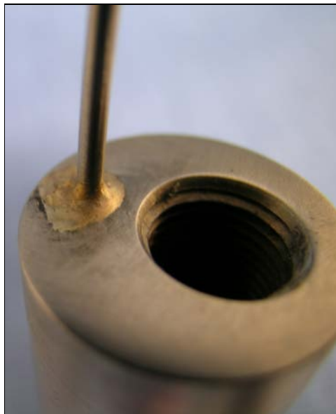
Abbildung 4.14: Edelstahlkapillare nach Ummantelung der defekten Schweißnaht mit einer Silberlotschicht
