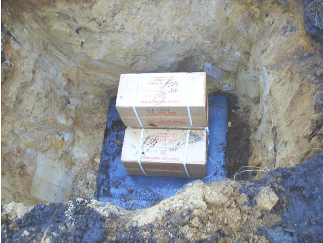
Bild 2: Versuchsaufbau 6b–Test (die Grube wird vor der Zündung zugeschüttet um eine ausreichende Verdämmung zu erhalten)
