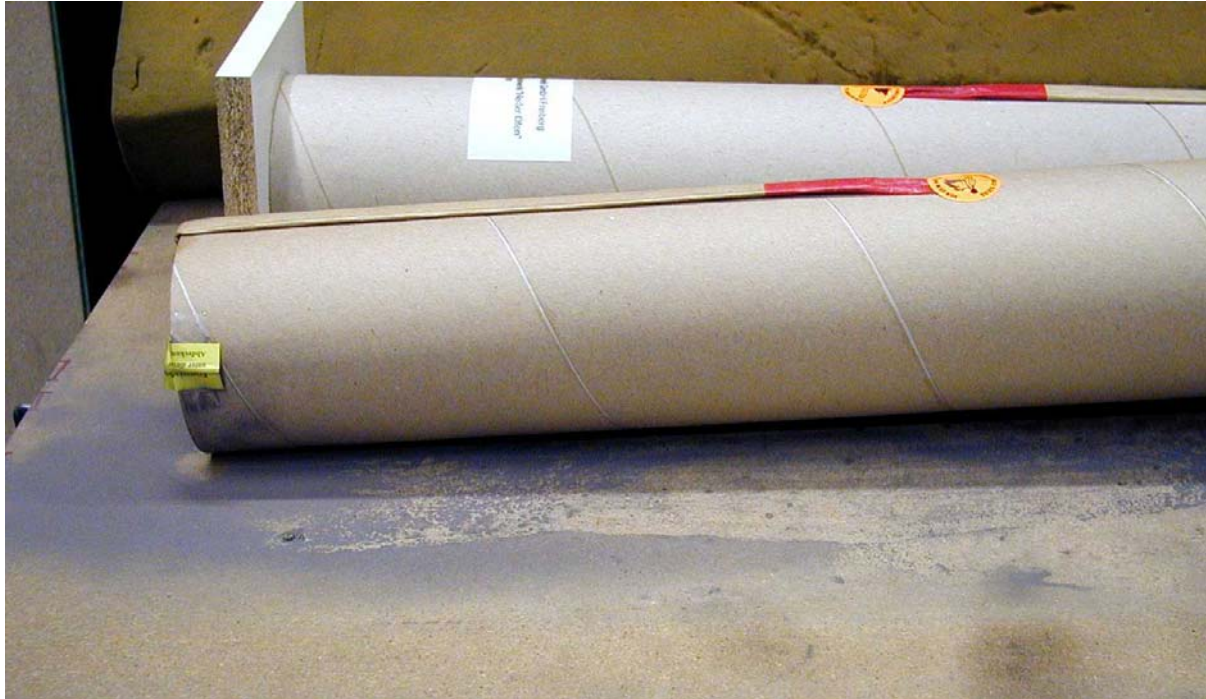
Bild 1a: Ausgerieselte Substanz nach dem Rütteltest
