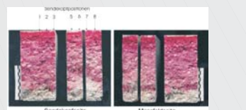
Die zerstörende Überprüfung ergab eine gute Übereinstimmung mit dem gemessenen Rissverlauf (Draufsicht auf die verfärbten Rissflanken).
