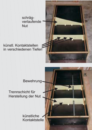
Die Schalungen der Rissprobekörper (Beton: Größtkorn 16 mm, Festigkeitsklasse B35) mit künstlichen Kontaktstellen, rissüberbrückender Bewehrung und Nuten.
