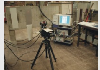
Gruppenstrahler-Sendeapparatur mit Laser-Vibrometer zur Messung der Richtcharakteristik in Durchschallung
