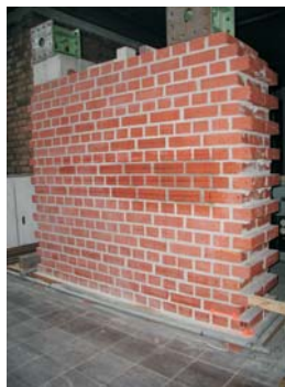
Abb. 4: Großer Mauerwerksprobekörper in der BAM Berlin, der Probekörper enthält mehrere Fehlstellen (Ziegelaussparungen) in verschiedenen Höhen und Tiefen, die Skizze deutet die Fehlstellen an.
