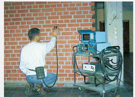
Abb. 2: Durchführung von Radarmessungen an einem Mauerwerksprobekörper
