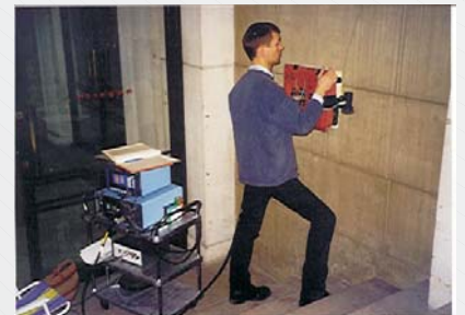
Abb. 3: Durchführung der Radarmessungen mit der 500 MHz Antenne.
