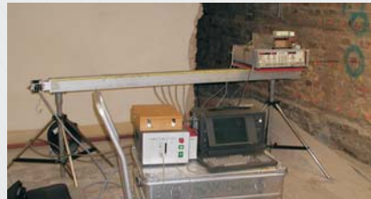
Abb. 4: Mikrowellen Messeinrichtung bei der Messung im Zeughaus Berlin
