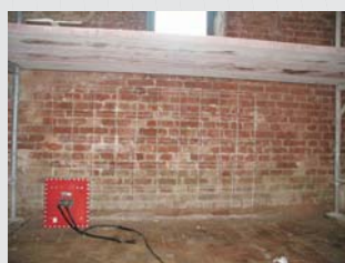
Abbildung 6: Messfläche III mit 16 Messlinien und 16 Messpunkten
