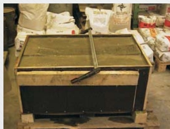
Bild 2: Betonschwelle eingelagert in Beton
