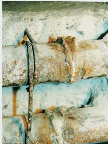
Sichtprüfung zur Beurteilung der Schweißnahtqualität
