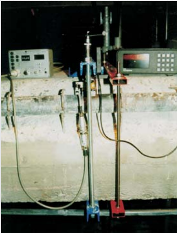
Statisches Verfahren zur Spannkraftermittlung
