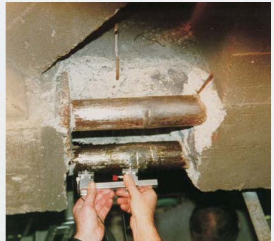
Sichtprüfung zur Beurteilung der Schweißnahtqualität
