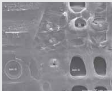
Polymatrix im Holz Mittels EDX werden (\text{SiO}_2)_x -Teilchen identifiziert.
