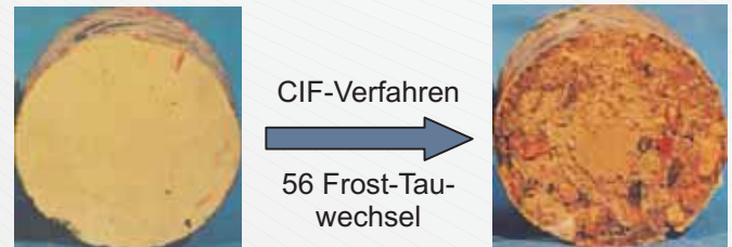
Abb. 2: Äußeres Erscheinungsbild der Prüffläche vor und nach der Frost-Tauwechsel-Beanspruchung
