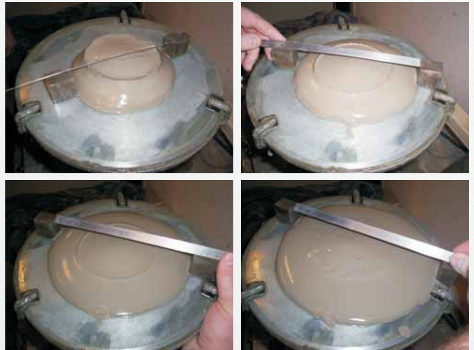
Abb. 1: Leimausbreitmaße bei Wasser/Feststoff-Verhältnissen von 1,1; 1,2; 1,3 und 1,4
