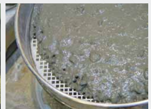
Abb.5: Siebversuch zur Ermittlung der Entmischungseigung
