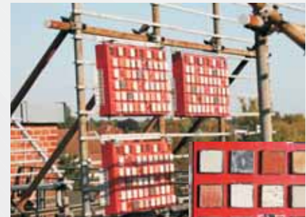
Bewitterungsversuch auf dem Stammgelände der BAM mit verschiedenen Antigrafitti auf unterschiedlichen Natursteinen
