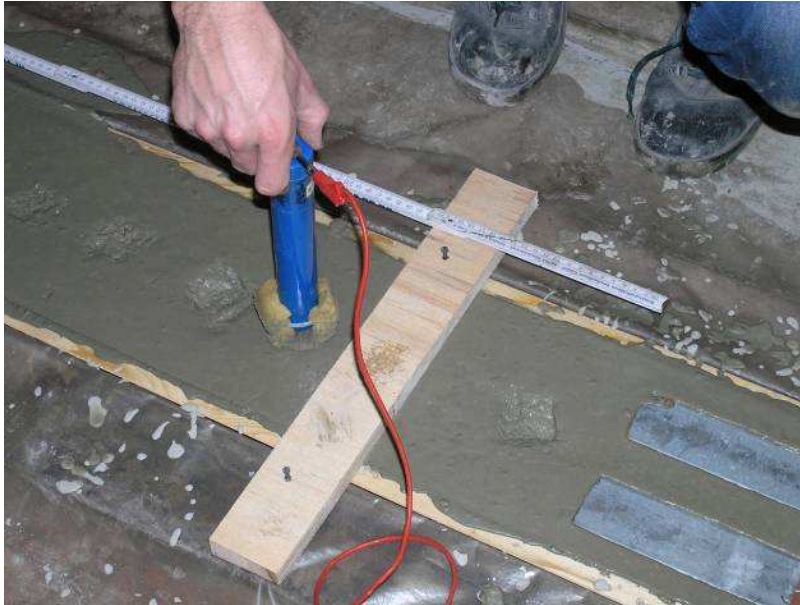
Bild 13: Potentialmessung am Probekörper mittels Aufsatzelektrode (Ag/AgCl; gesättigt)
