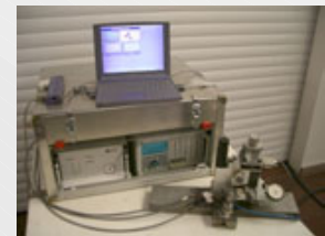
Meßkette zur Eigenspannungsanalyse an einer geschweißten Großprobe aus S355 (Bohrvorrichtung, Kontrollsystem und Meßverstärker, PC)
