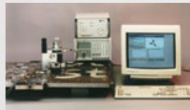
Meßkette zur Eigenspannungsanalyse an einer geschweißten Großprobe aus S355 (Bohrvorrichtung, Kontrollsystem und Meßverstärker, PC)
