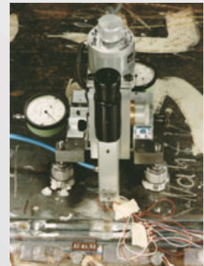
Bohrvorrichtung und optische Justierung an einer Schweißnaht
