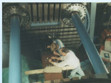
Applizieren von Dehnmeßstreifen und Thermoelementen auf einer Großprobe in der GAPSI 16
