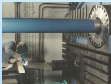
Verbindungsschweißen von zwei ebenen Blechen aus höherfestem Feinkornbaustahl TStE 690 V unter starrer Einspannung in der GAPSI 16
