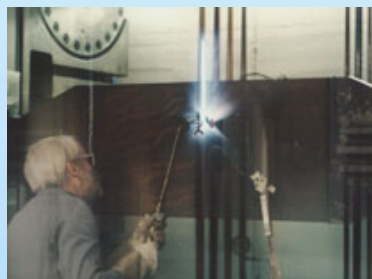
Bestimmung von Dehnungs- und Schrumpfungsvorgängen beim thermischen Richten (Flammrichten)
