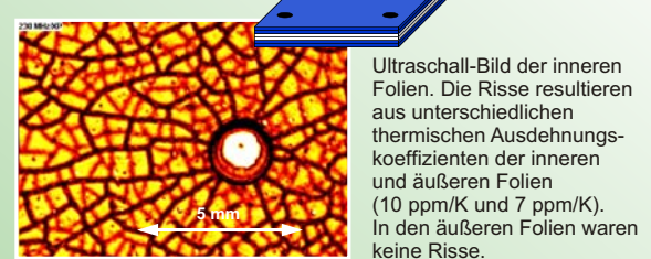
Gesinterter LTCC-Schichtverbund bestehend aus Folien unterschiedlicher Zusammensetzung
