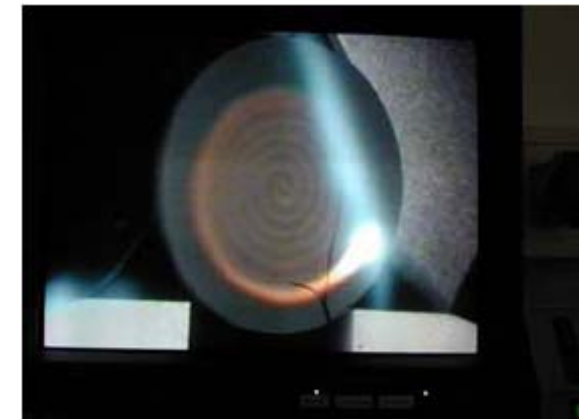
Bruch einer Probe nach Überschreitung der kritischen Thermospannung
