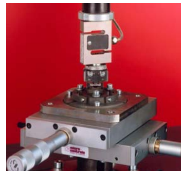
4-Punkt-Biegeprüfung an Folien und Substraten
